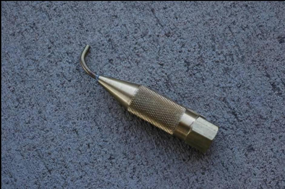
Tubo de Pitot y un manómetro de 100 psi)
