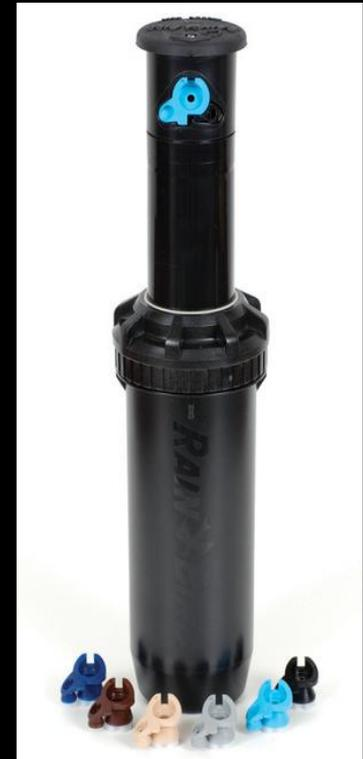
La tasa de aplicación indicada en los catálogos, es solo para un arco de 180 grados. Para un círculo completo, la tasa de precipitación es la mitad del valor de la tabla
